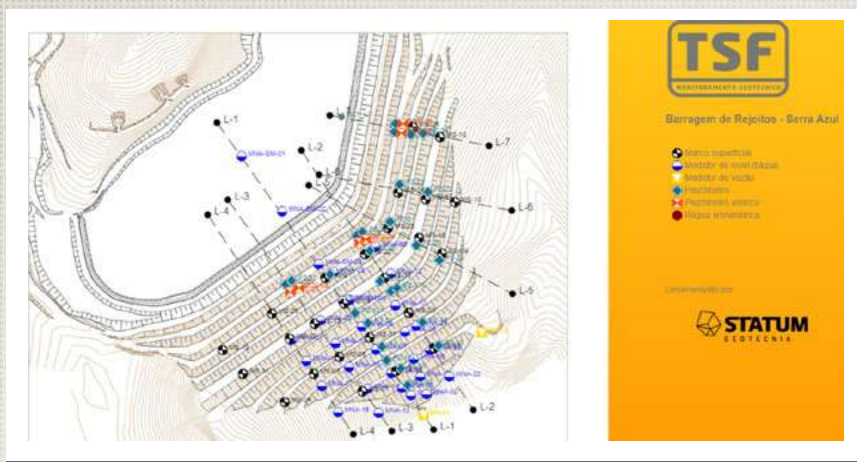
Imagem 03: Monitoramento geotécnico de barragem da ArcelorMittal
